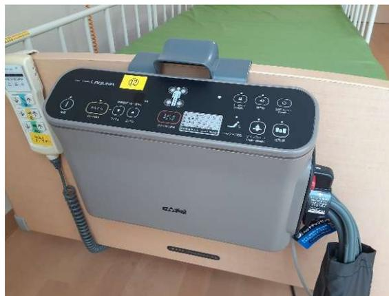
▶骨盤を中心に対角線上の小さな体位変換を自動で行うことにより、ズレがなく、違和感のないエアマットレスのため、褥瘡（床ずれ）を防止しようとする補助具。
